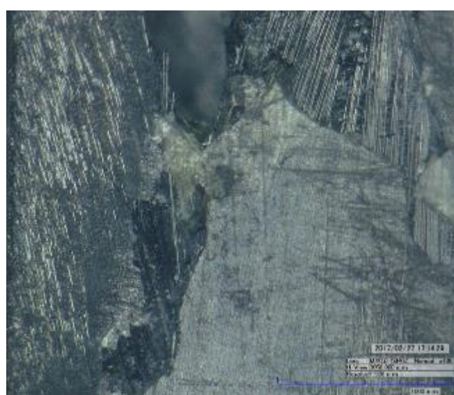
Fig 7 30° longitudinal tensile speicemen damage morphology
